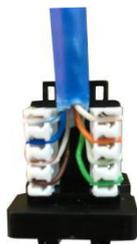
将网线按左图方式分别插入对应的槽位内，其中有两种插入的形式 如下
